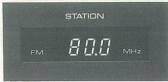
▶選局中に局と同調するとその局の周波数をデジタル表示するSTATIONインジケータ (MUTING OFF時は、常に同調周波数を表示します。)
