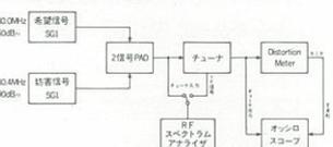
Fig13は、DXポジションとLOCALポジションでの受信状態をFig12のブロックダイアグラムで見たものです。写真Aは受信機のアンテナ端子の入力信号スペクトラムで、左側が希望信号で80.0MHz・50dBμ、ステレオ100%変調、右側が妨害信号で80.4MHz・90dBμ1kHz・100%変調になっています。この場合ですと希望信号より妨害信号のほうが40dB=100倍強力な状態にセットされているわけです。写真BはLOCALポジションでの受信状態で、希望する80MHzの信号が80.4MHzの強力な信号によって妨害を受けています。この時のチューナ出力と歪波形を見たのが写真Bですがかなり乱れているのがわかります。写真CはDXポジションでの受信状態で80.4MHzの妨害信号は実にシャープにカットされて
